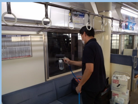
車内への抗菌コーティング施工
